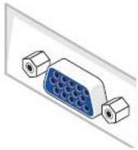
**NOTE:** Se il computer è dotato di un connettore bianco DVI, svitare e scollegare il cavo blu (VGA) dal monitor. Collegare il cavo bianco DVI al monitor ed il connettore bianco DVI al computer.
