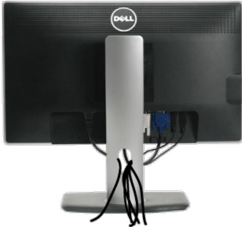
Dopo aver fissato tutti i cavi al monitor e al computer, (Si veda [Collegamento del Monitor](#) per i collegamenti dei cavi,) usare il passacavi per organizzare i cavi in maniera ordinata, organizzare tutti i cavi come mostrato sopra.
