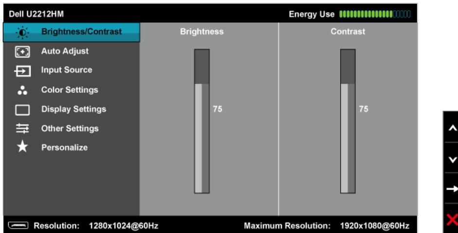
**NOTA:** L'opzione AUTO ADJUST (Regolazione automatica) è disponibile solo quando si usa il connettore analogico (VGA).
